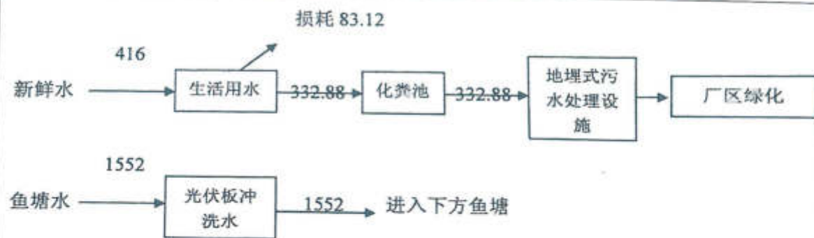
图 2-1 项目水平衡图 (m³/a)
