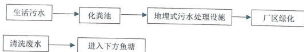
图 3-1 项目生活废水处理流程图
